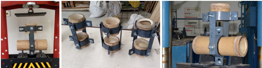
8 Prototipos de abrazaderas y platinas Martínez M.
