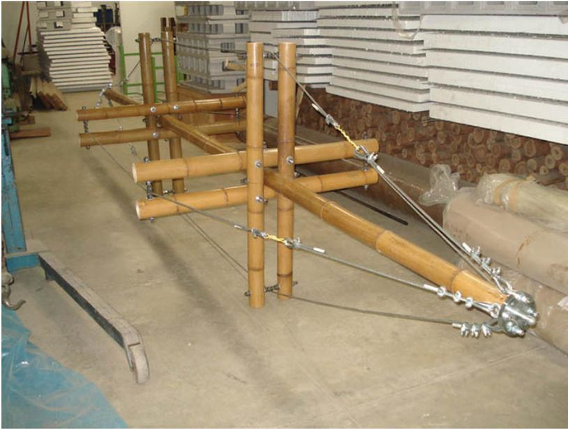
*Figura 1: Forma da coluna híbrida montada com os cabos de aço.*
