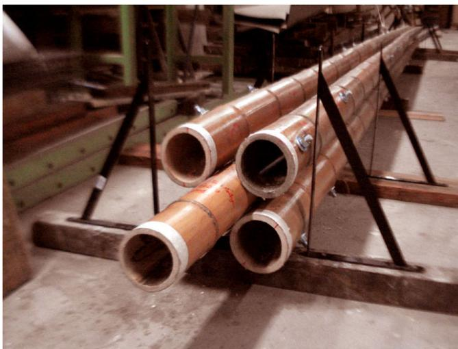
Figura 2: Forma da coluna composta, com elementos espaçadores internos.
