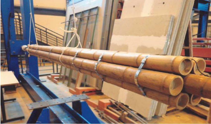
Figura 3: Forma da coluna em feixe com as cintas metálicas ao seu redor.
