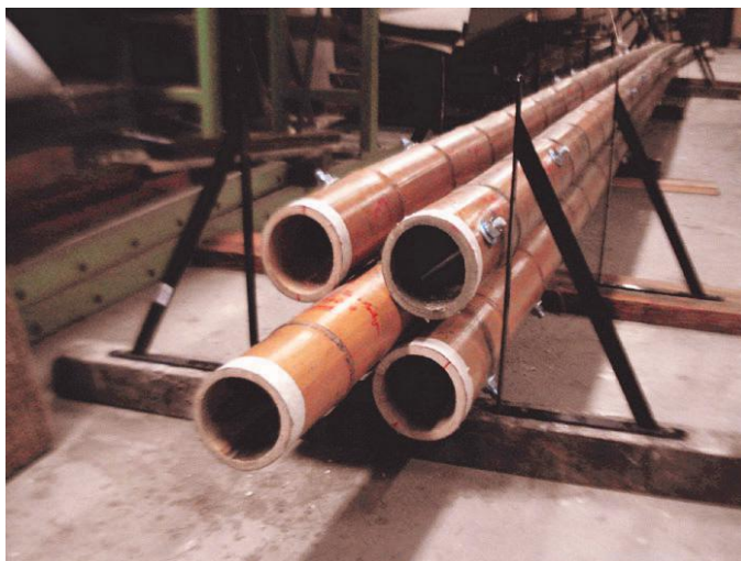
Figura 2: Forma da coluna composta, com elementos espaçadores internos.
