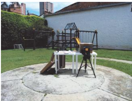
Figura 30. Espacio abierto para la toma de fotografías y toma de referencia de lx al interior de la maqueta. Producción del autor.
