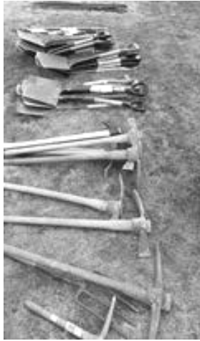
Figura 65. Utensilios utilizados en la extracción manual
