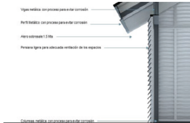
Imagen 502. Detalle de partes de la fachada.
